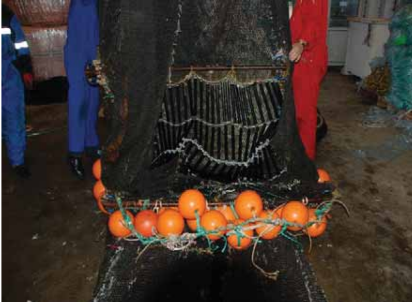
Figur 6. Jernstang for avstiving av Flexipanel oppe (nærmest) og nede (stang lengst unna). Jernring i endene for avlastning mot nettpanelet, samt lette å kunne montere
