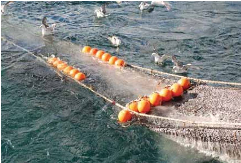
Figur 7. Fløytkuler på overpanel ristseksjon. Mye kledning av laksesild/plankton foran Flexipanel.
