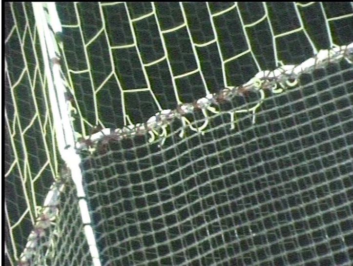
Figur 12. Sammenføyning mellom mursteins- og kvadratmasker
