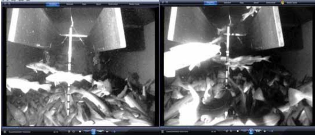
Figur 3. Typisk skjermbilde fra videoovervåking (her fra forsøkstank under etasjeskiller). Luken i etasjeskiller er her åpen under innlasting av fisk. Midt i bildet ser vi målestang som ble brukt til å beregne tettheter av hvilende fisk. Stangen har merker for hver 10 cm. På bildet til venstre er det et lag på ca 20 cm fisk (ca 700 kg*m 3 ) som ligger tett i tett oppå hverandre mens det til høyre er ett lag på ca. 50 cm (ca 650 kg *m 3 ).
