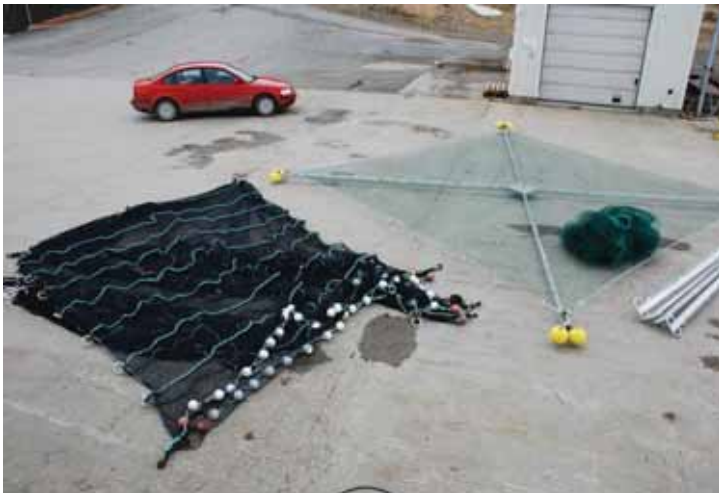
Figur 6. Rammeverk med stramt bunnpanel (=trampolinebunn). Lagringspose påmontert fløyt, ringer for opphalingsvinsjer samt megaflyt (flytetau) for samling og flotasjon av løst nett når merden skal heises opp og tømmes for fisk.
