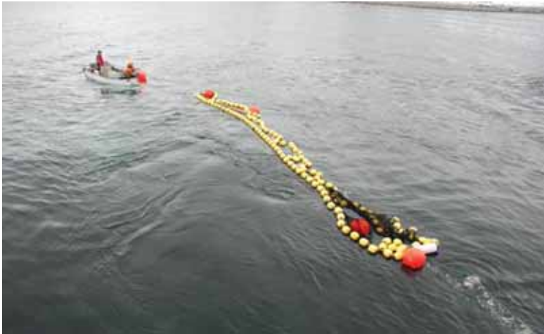
Figur 9. Lagringsmerden slepes over bord fra M/S "KILDIN". Merden er så langt rigget med blåser samt merdestang i bakre ende av posen.
