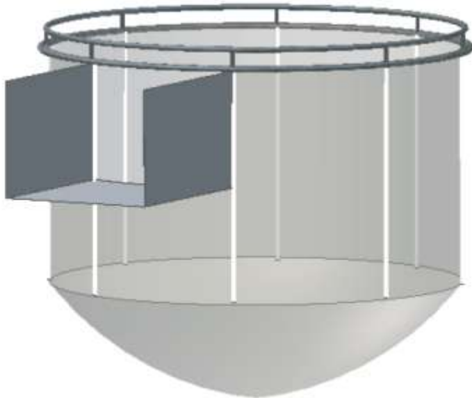
Figur 1. Skjematisk teikning av merd med kanal som vart konstruert til forsøka.
