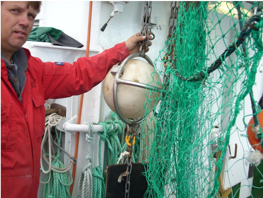
Figur 5. 11”s plastbobbins montert i samme ramme som stålbobbinsen vist på bildet i Figur 4.
