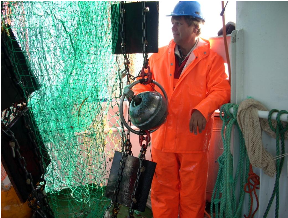
Figur 4. 9”s stålbobbins montert i en sirkulær stålramme med aksling som diameter.
