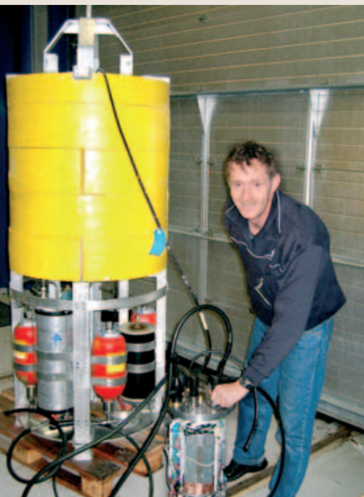
Spesialutvikla batteri, kunstige symjeblerer og antenne til Iridium satellittelefon, som toler 1000 m trykk.
