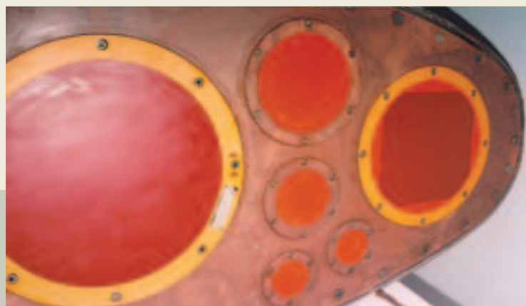
Senkekjøl frå underside. Svingar montering, 6 EK60, med frekvensar frå 18–364 kHz.
