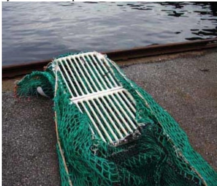
*Eurorista er laga av glas-fiber. Ei rist på 60 x 120 centimeter veg berre 9 kilo. Teknisk fungerer prototypen godt. Prøvefiske viser at rista kan justerast for å oppnå optimal seleksjon.*
