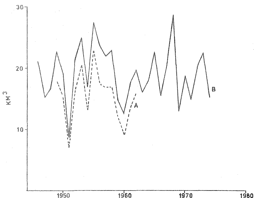
Fig. 3. Beregnet 30-døgnsmaksimale flomtop fra Møre-Trøndelag av Skreslet (1976), A og NVE/HI, B.
