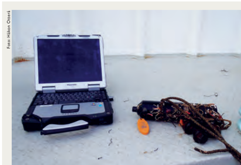
Figur 2. Lyttebøyer (til høgre i bildet) som denne lagrar informasjon som blir sendt ut frå merkt sei som er i nærleiken. Ei datamaskin blir brukt til å henta ut informasjon frå bøylene.
