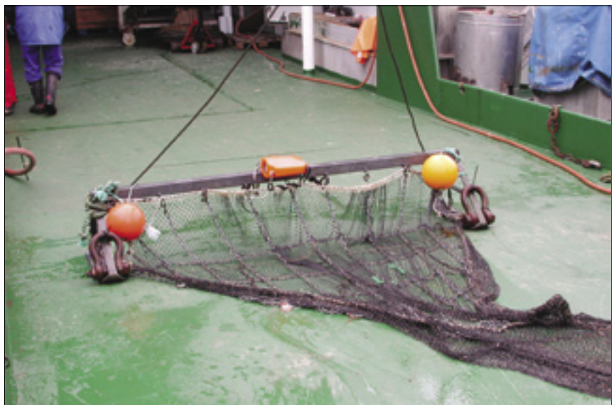
Figur 2.3.5.2 2 m bomtrål, standardredskap for prøvetaking av bløtbunnsfaunaen. 2 m beam trawl, the standard gear for sampling soft-bottom epibenthos.
