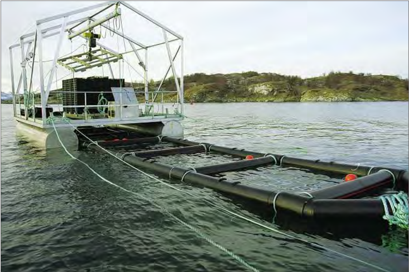
Figur 5.8.2.3 Sjøbasert oppbevaringsteknologi for oppfôring/oppdrett av kråkebolle. Sea based holding technology for feeding and rearing of sea urchin.
