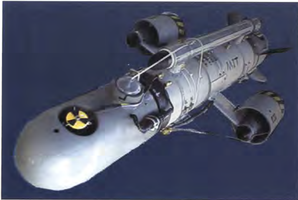
Figur 5.41 Eksempel på selvstyrt undervannsfartøy (AUV- Autonomous Underwater Vehicle) utviklet ved MIT. Den typiske AUV er 2- 3 m lang med 10 - 100 liter nyttelastvolum for utstyr og instrumenter. Fremdriften til AUV-fartøyer er basert på elektrisk strøm fra batterier eller fra brenselceller. Foto: MIT.
