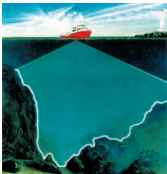
Figur 6.23 Sjøkartverkets "Sjømåleren". Kartlegging foregår med et flerstråle-ekkolodd som sender ut mer enn 100 stråler samtidig. Dette gir et meget detaljert og flatedekkende bilde av havbunnen. Et vanlig "fiskelodd" bruker bare en stråle. Sea bed mapping using multibeam swath bathymetry. The echosounder uses more than 100 beams simultaneously. The result is a very detailed map of the sea floor.
