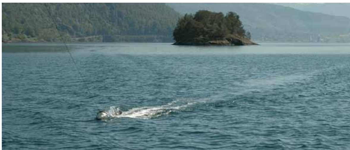
Saltholdighet og temperatur i overflaten måles med en slepesonde i Etnesfjorden. Salinity and temperature are measured with a towed sensor in Etnesfjorden.
