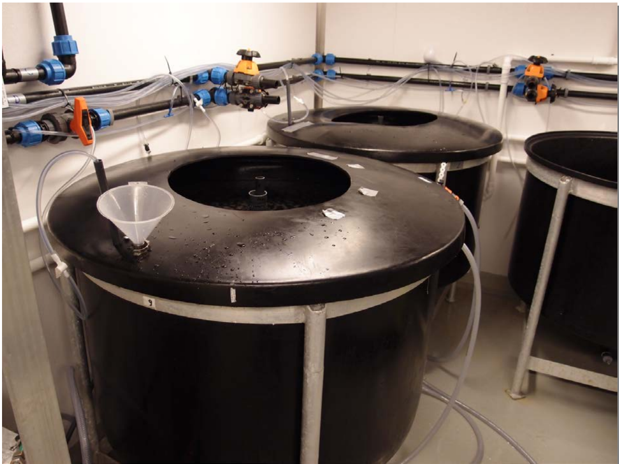
Figur 5.2.3: Karoppsett med trakt for tilsetting av plankton under oljelaget i overflaten.
