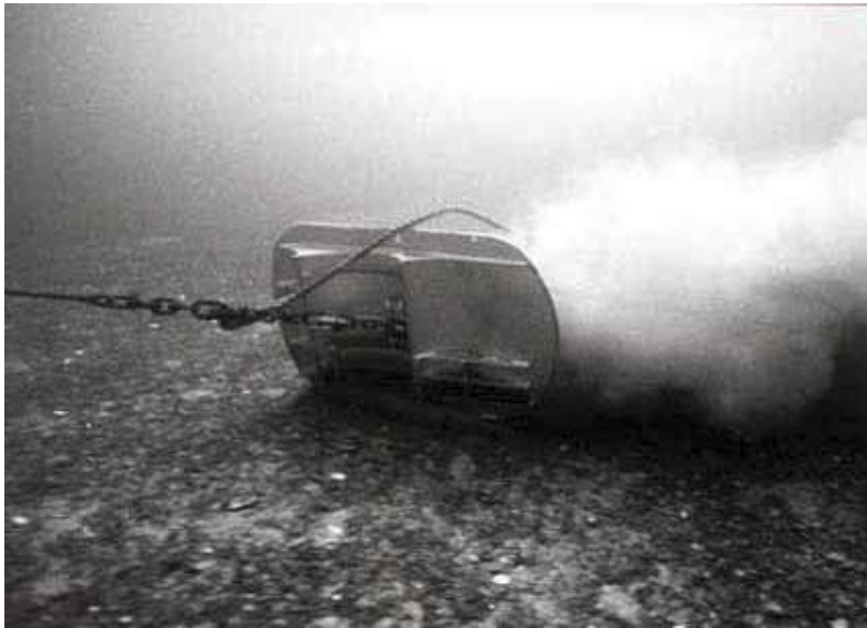
Figur 5.10. Sandskyen som følger trålen viser hvordan trålen kan virvle opp bunnpartikler (fra Breen 2004).
