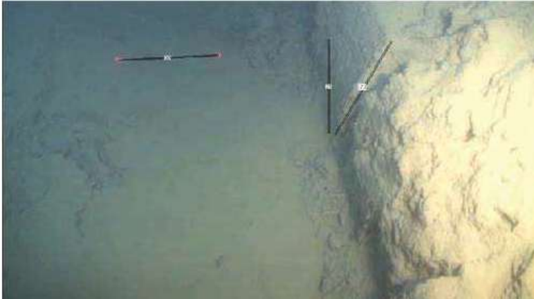
Figur 5.2. Spor etter døren på rockhoppertrål i mykt mudder i Varangerfjorden. Avstanden mellom de røde laserlysene er 10 cm (fra DEGREE 2010).
