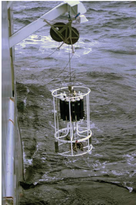
En CTD-sonde med vannhenterne på vei opp fra havet. Foto: Cecilie Broms.
