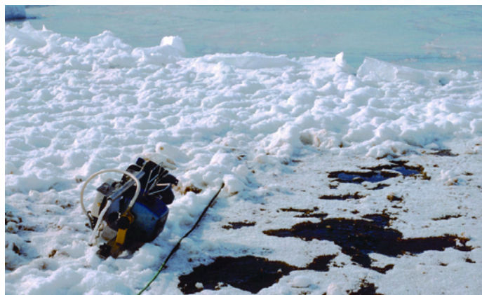
Figur 69 Forsøk hvor olje blir sluppet ut i et område med drivis.
