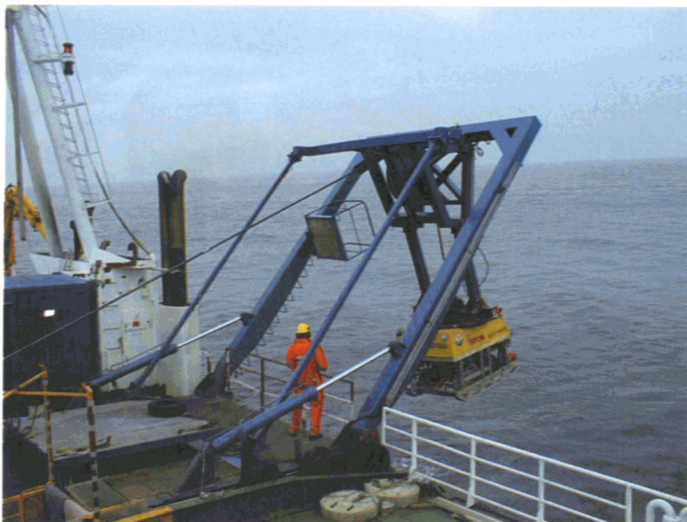
Fig. 3. Utsetting av Triton-ROV fra "Geograf". Viser det kraftige kransystemet som skal til for å sette ut og ta inn en stor ROV på en sikker måte. Launching of a Triton-ROV showing the heavy cranes necessary for safe operation of a large ROV.
