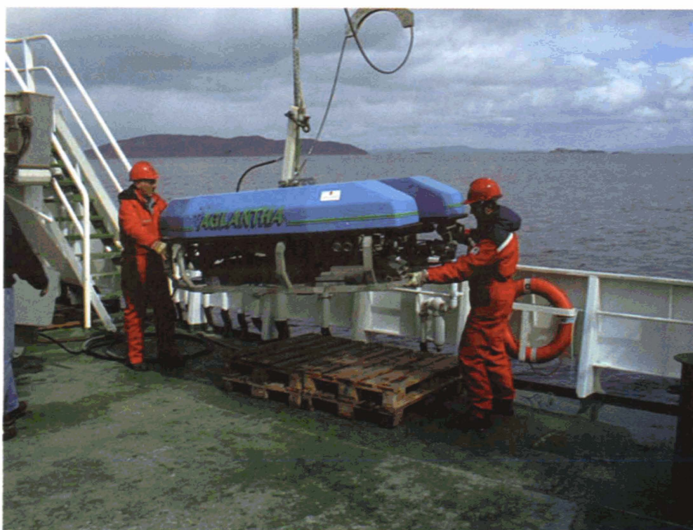
Fig. 4. Universitetet i Bergen har utviklet en ROV, "Aglantha", som kan gå ned til 2000 m. Denne ble brukt fra "Johan Hjort" i 1999 på de store korallrevene ved Nord-Leksa og Sula-revet. Den ble også brukt til å undersøke forholdene ved Ivergrunnene nord for Haltenbanken og ved Sklinnabakken. The University of Bergen has developed an ROV, "Aglantha", which can operate at 2000 m depth. It was used to study deep-water coral reefs in 1999.
