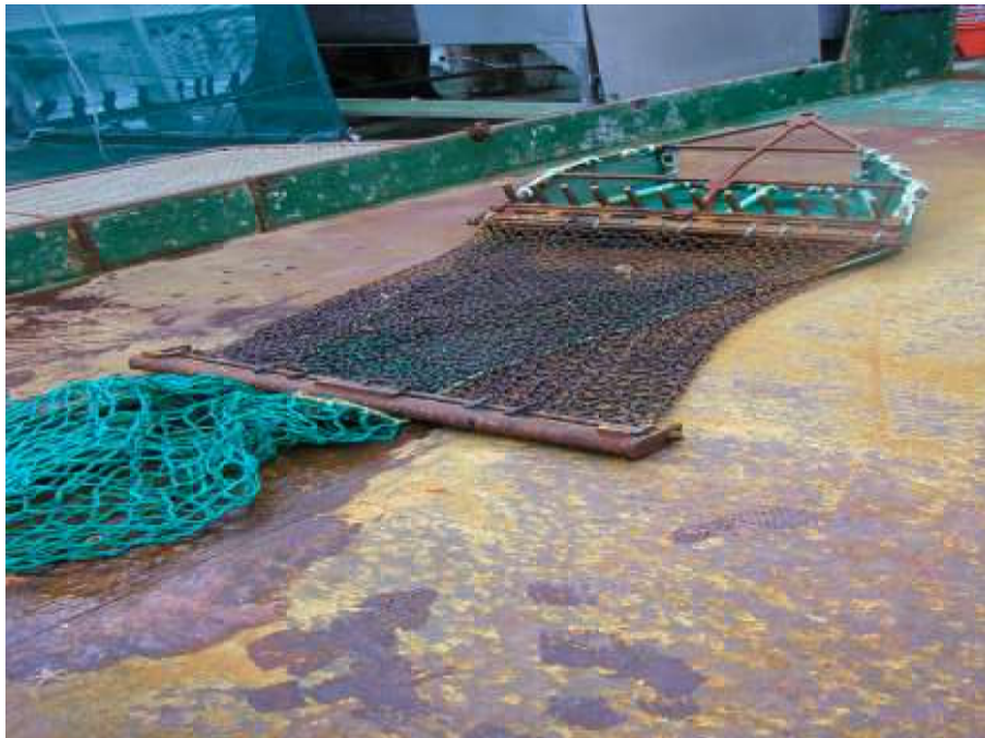
Fig. 6 Muslingskrape fra underside med ringbrynje. Standard oppsett bruker 10 mm vaier med en lengde som er 3 ganger bunn-dyp pluss 50 m. Slepefarten er 2 knop og tauetiden er 10 minutter fra stopp slakk til start hiv.
