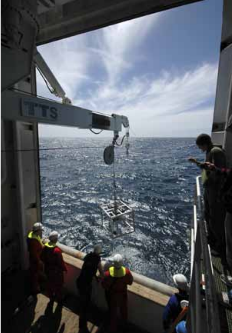
▲ Oppsamlingsbatteriet som tar seks kjerneprøver løftes ut av hangaren og låres ned til 3000 meter. Foto: KM.
