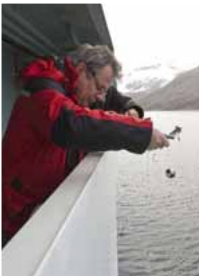
▲ Kalibreringskulene er av ulik størrelse og må byttes ut avhengig av hvilken ekkoloddfrekvens som kalibreres. Her er Martin Dahl i sving med kulebytte. Foto: KM.
