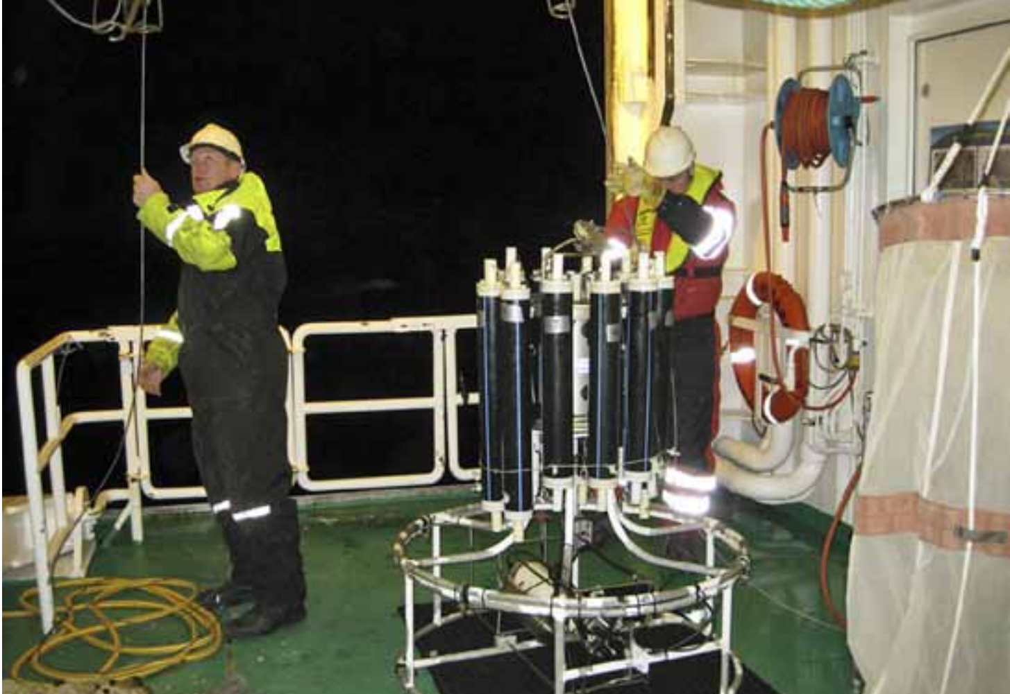
▲ CTD-sonde med vannhentere klar for innsats i dypet. Planktonhåv sees til høyre på bilde. Foto: EB
