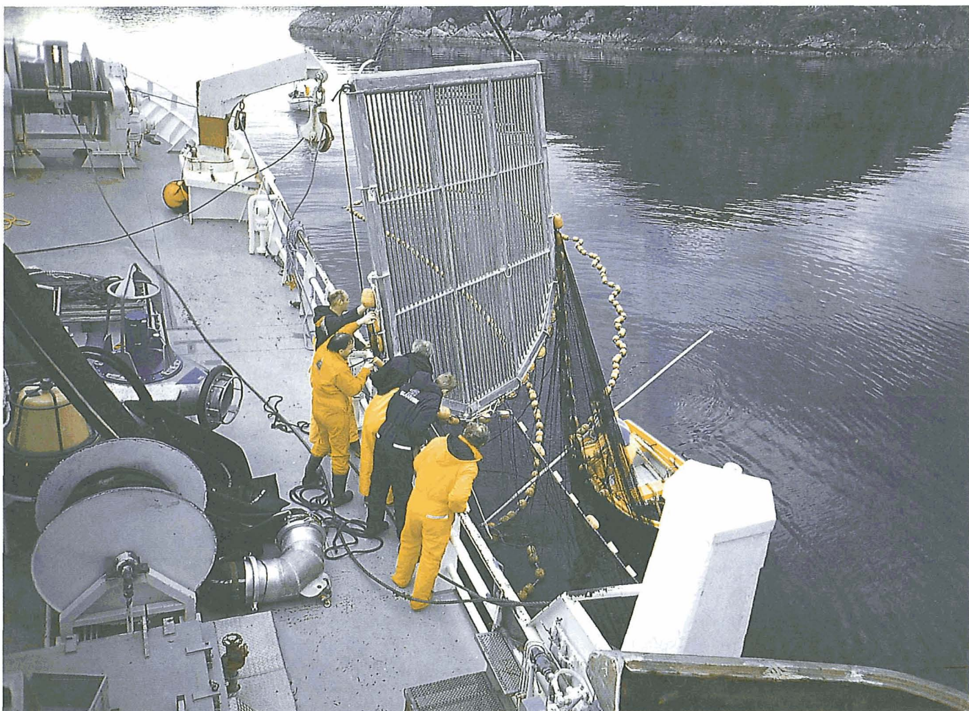
Utprøving av skiljerist i makrellnot. Foto: Fangstseksjonen
