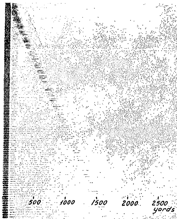
Fig. 3. Registrering av sildestim på ASDIC og ekkolodd i Sirahavet 20. februar 1946.
