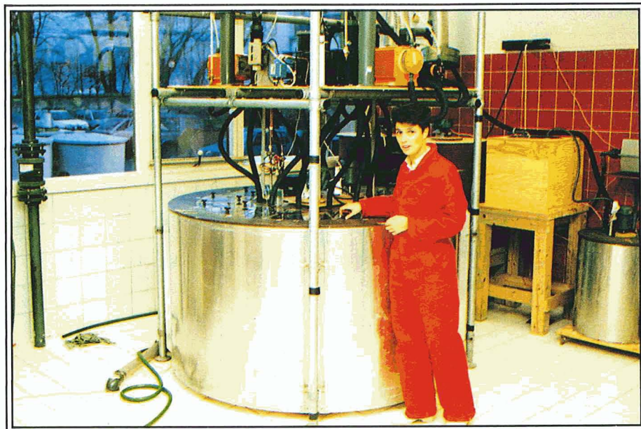
Biotestanlegg til undersøkelse av oljens effekt på fiskeegg og -larver. Foto: B. Serigstad.
