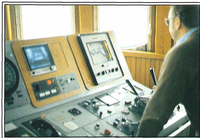
Panel med instrumenter for tråling ombord i F/F «G. O. Sars». Foto: H. P. Knudsen.
