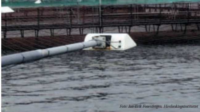
Bilete 1. Overvasslys (5 x 400 W metallhalogenlampar) på matfiskanlegg i Austevoll.
