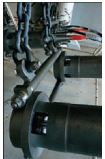
KANON: En rekke luftkanoner av denne typen avfyres samtidig hver 10. sekund. ILL. FOTO
