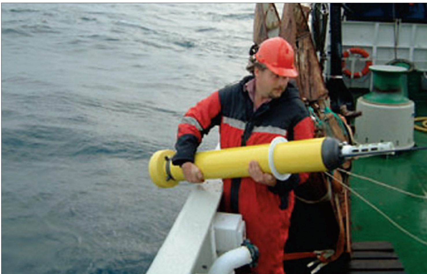
INFORMANTEN: Utsetjing av argon-bøye. Med ei levetid på fire år gjev kvar av desse 3000 bøyane frå seg mykje viktig informasjon om havet. ILL. FOTO: HI.
