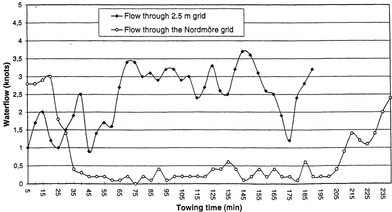
Fig. 3.2. Vannstrøm (i knop) gjennom stor og vanlig Nordmørsrist under tauing ved 3.0-3.2 knop, Svalbard januar-februar 1996.
