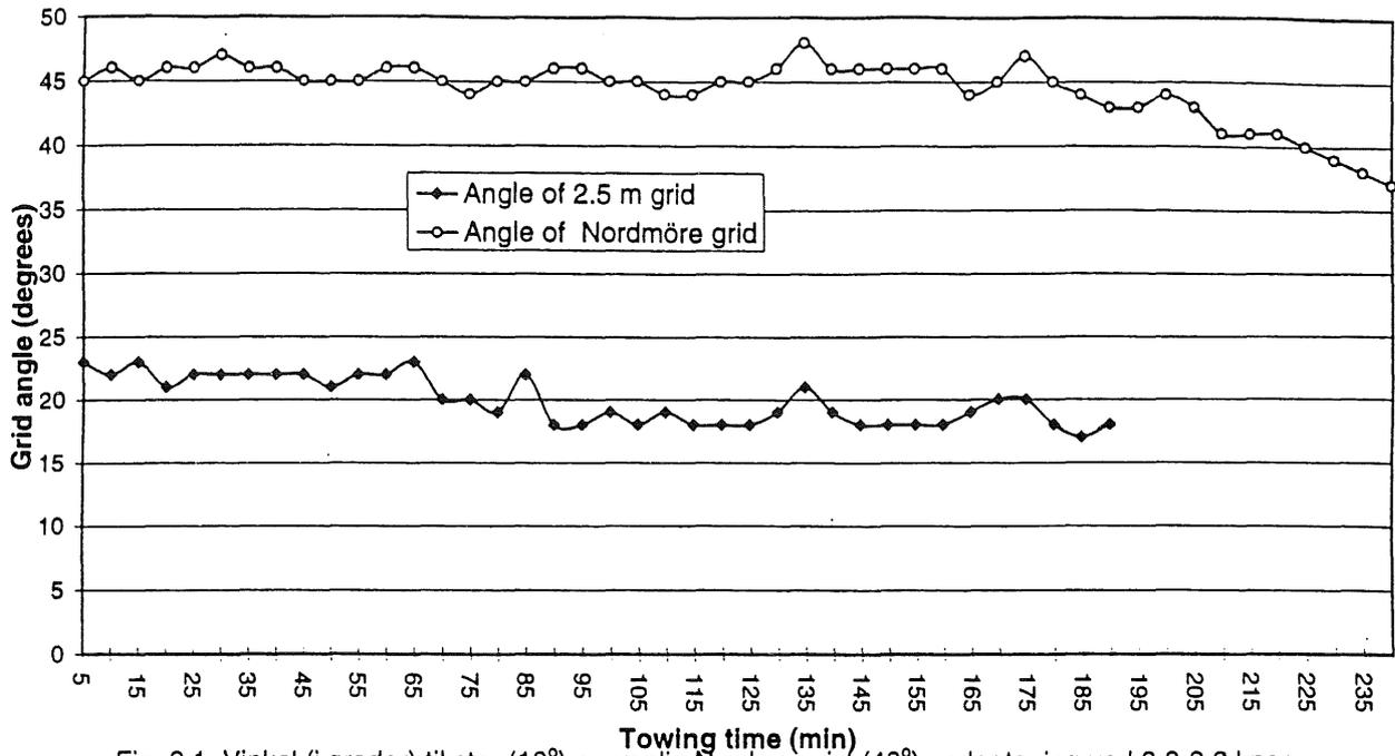
Fig. 3.1. Vinkel (i grader) til stor (18°) og vanlig Nordmørsrist (48°) under tauing ved 3.0-3.2 knop, Svalbard januar-februar 1996.
