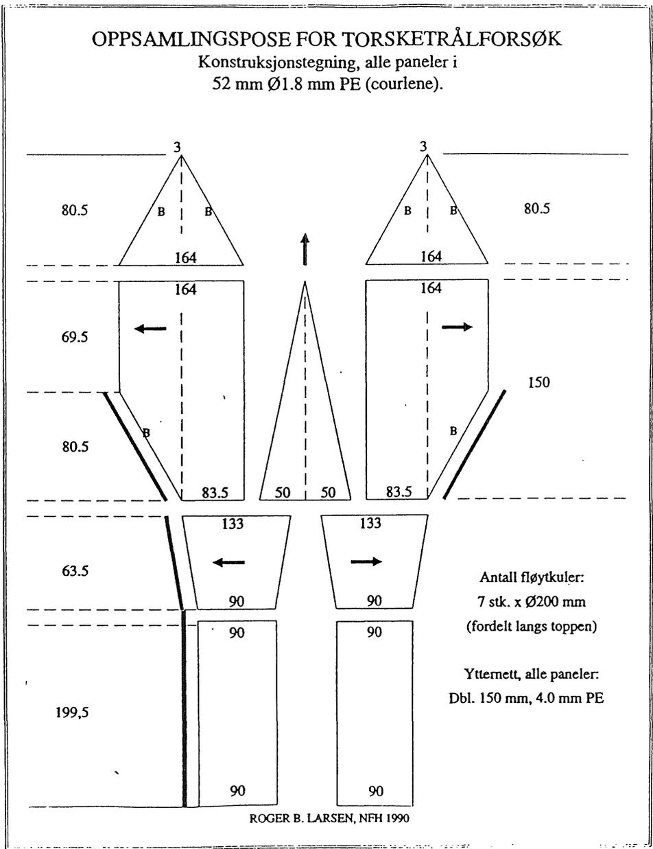
Figur 5: Konstruksjon av oppsamlingspose for seleksjonsforsøk.
